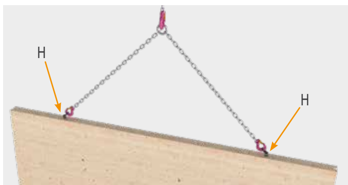
Anheben einer stehenden Wand mittels zwei montierter Hebeanker HebeFix Mini und Kugeltragbolzen (H) an der Schmalseite.
