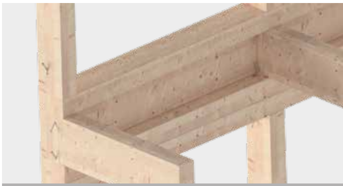
Befestigung von Stützen bei Holz-Rahmenkonstruktionen sowie Haupt-/Nebenträger-Anschlüssen
