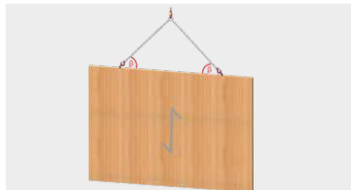
BSH-Wand oder-Träger stehend, Faserverlauf: vertikal
