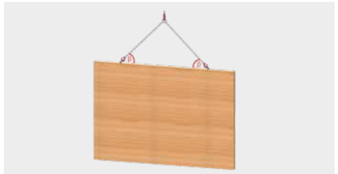
BSH-Wand oder-Träger stehend, Faserverlauf: vertikal
