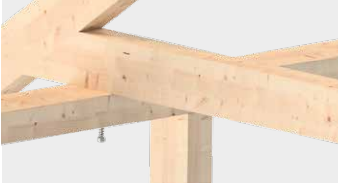
Befestigung von Querträgern bei leichten Holz-Rahmenkonstruktionen
